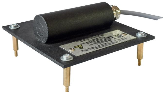
Конструкция нагревателя ТЕРМИТ-ОУР выполнена в виде позисторного нагревателя установленного внутри корпуса расположенного на пластине. Изделие выполнено в компактном корпусе и предназначено для установки в термошкафы/термочехлы небольших объемов.
